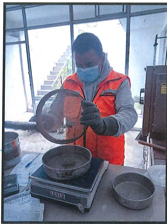
ENSAYO DE GRANULOMETRÍA
