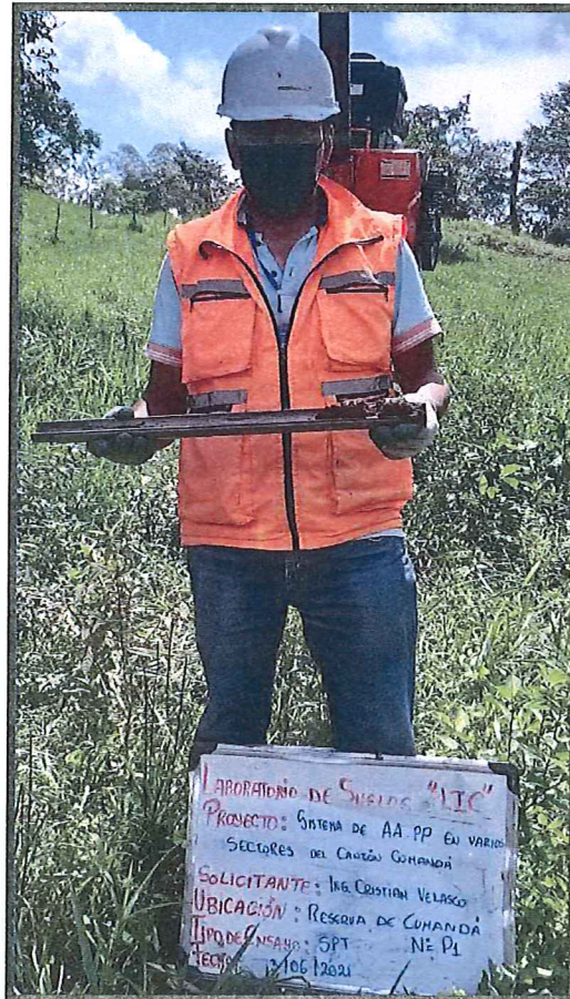
TOMA DE MUESTRA PERFORACIÓN PUNTO P1 PROFUNDIDAD 5.50 - 6.50 m.
